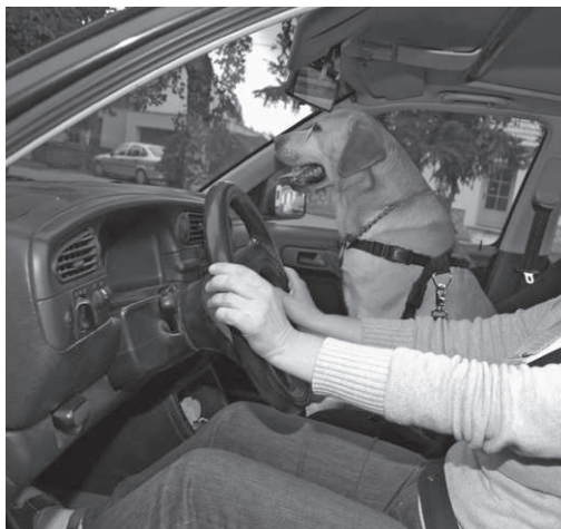
Obr. č. 11 Pes připoutaný v postroji zajištěném v systému bezpečnostního pásu
