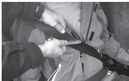
Obr. č. 3 Provedení šikmého řezu pomocí řezače
