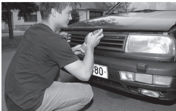
Obr. č. 14 Aplikace hasiva do prostoru motoru pootevřenou kapotou
